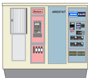
CITI 10R + AI 01/400 SEC 400 Sin bancada 1350 x 1880 x 400 mm Con bancada 1570 x 1880 x 400 mm
